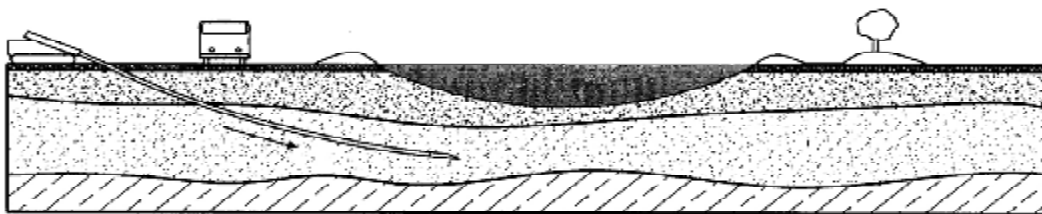
Rys.1) Przewiert pilotażowy
